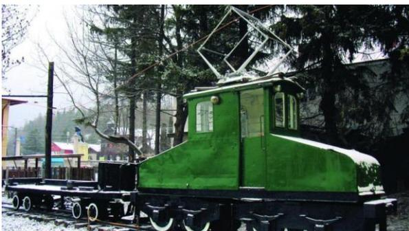
Bis heute im Internet bestaunt wird die **elektrische Schmalspurbahn** in der Fabrik. Sie war die erste elektrische Eisenbahn Rumäniens. Zwischen 1900 und 1913 erwarb Samuel Schiel insgesamt drei Lokomotiven in Deutschland. Aufsehen erregte Samuel Schiel auch mit seinem Elektroauto, mit dem er ab 1907 seine täglichen Fahrten
